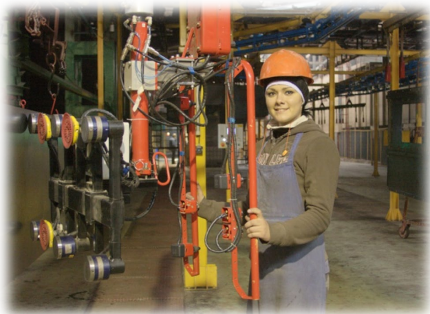
Загрузка панелей при помощи манипуляторов
