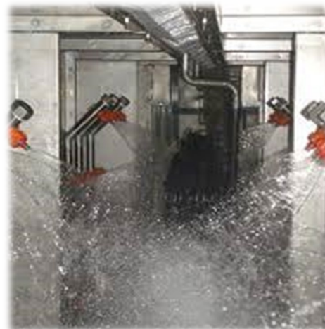
Подготовка поверхности струйным обливом
