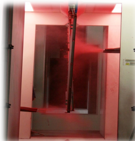
Автоматическая кабина Wagner для нанесения порошковой краски
